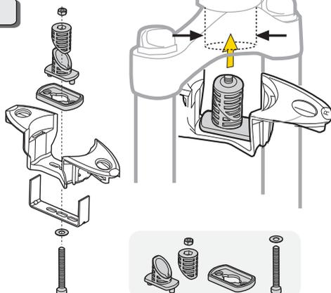
Fits  $\varnothing 27.7 \sim \varnothing 35$  mm
